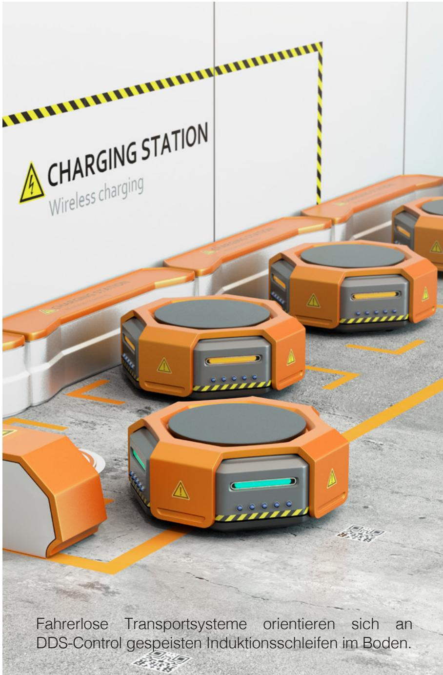
Fahrerlose Transportsysteme orientieren sich an DDS-Control gespeisten Induktionsschleifen im Boden.
